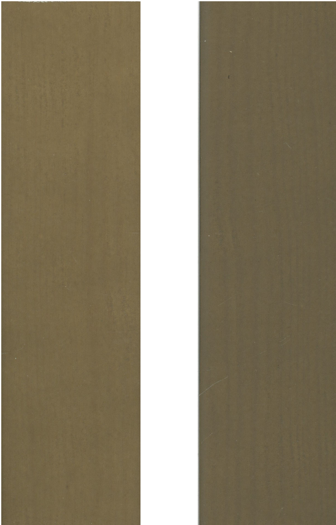
Abbildung 2: Probe 2 - Kiefer mit „KH Aqua Holz HL120, Farbton Akazie“ und „KaWaTech Holz Finish HMSS“ beschichtet - unbewittert (links), nach 1 Jahr Freilandbewitterung (rechts)
